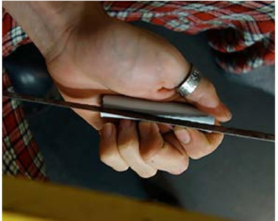
Couper ce morceau de tuyau dans le sens de la longueur avec une scie, 2 fois, de façon à retirer 1 cm de circonférence sur toute la longueur du tuyau. Ceci permettra de réduire le diamètre extérieur de ce connecteur afin qu'il puisse s'insérer dans le diamètre intérieur du reste du cerceau
